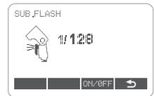
Wenn das Zusatzblitzlicht eingeschaltet ist, kann die Blitzleistung des Zusatzblitzlichts mit dem rotierbaren Einstellrad eingestellt werden. Insgesamt 22 Gänge der Blitzleistungen sind verfügbar. Der Einstellbereich beträgt 1/128-1/1. Einmal gedreht, wird es im Schritt von + 1/3-Gang eingestellt.
