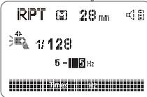
3. Drücken Sie kurz die Taste < +/- >, um den Blitzausgangswert auszuwählen, und drehen Sie dann das Einstellrad, um den Blitzausgangswert einzustellen. Drücken Sie nach der Einstellung kurz die Einstellaste, um die Einstellung abzuschließen.
