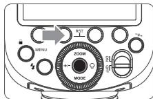
1 機能ボタン2 <SYNC> を押して、パネルに <Fn> アイコンを表示させます。
