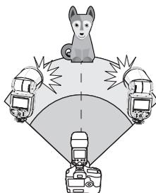
より大きい発光出力を必要としたり、より手軽に照明を行ったりする場合、スレーブユニットの数量を増やして単独のフラッシュとして発光させます。スレーブユニットを追加する場合、「一つのスレーブユニットによる自動フラッシュ撮影」と同じステップを使って、いかなる発光グループ(A/B/C/D/E)を設定できます。スレーブユニットの数量を増やしたり、マスターフラッシュの発光はONに設定されたりした場合、あらゆるフラッシュは同じ発光出力で発光し、トータル発光出力が標準露出に達するように自動制御を行います。
