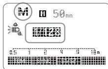
2 <+/->ボタンを押して選択し、調整つまみを回して発光出力を設定します。
