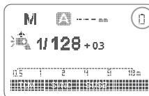
Wenn die Batterie schwach ist, blinkt das Batteriesymbol < > , bitte tauschen Sie in diesem Fall die Batterie aus.
