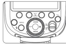
**1** Drücken Sie die Taste < $\pm$ >, um das Symbol < $\pm$ > anzuzeigen, und der Wert für die Blitzbelichtungskorrektur wird hervorgehoben.
