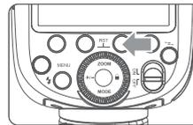
**1** Wenn Sie die Funktionstaste <FEB> drücken, wird das Symbol <FEB> angezeigt und die horizontale FEB-Anzeige 7F hervorgehoben.
