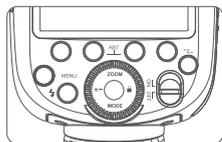
1 按下<+/->按钮，令屏幕显示<1/2>图标，并且闪光曝光补偿量被突出显示
