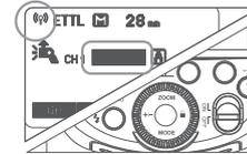
Drücken Sie die Taste < [Blitzmodus] > damit der Bildschirm < [E-TTLII] > or < [Manueller Blitz] > are angezeigt wird.
