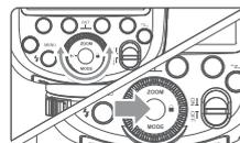
**3** Drücken Sie die Set-Taste, um die FEB (Flash Bracketing Exposure) zu bestimmen. Die Bildschirmanzeige springt auf die Anzeige der Blitzbelichtungskorrektur und der Blitzbelichtungsreihenwerte.
