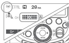
按下< 无线设置 >按钮,令屏幕显示< 无线设置 >和< RX >。
