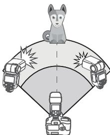
Wenn eine höhere Blitzleistung erforderlich ist oder wenn Sie einfacher blitzen möchten, können Sie die Anzahl der Slave-Geräte erhöhen und sie als einen einzigen Blitz verwenden. Um ein Nebengerät hinzuzufügen, gehen Sie genauso vor wie bei "Automatische Blitzaufnahmen mit einem Nebengerät", um eine beliebige Blitzgruppe (A/B/C/D/E) einzustellen.
