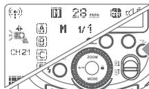
按下< 无线设置 >按钮,令屏幕显示< 无线设置 >。
