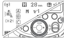
Drücken Sie die Taste < [Wireless Setup] > Wireless Setup, so dass auf dem Bildschirm < [Aus] > angezeigt wird.
