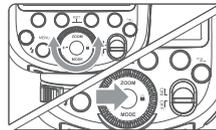
**3** Drehen Sie den Einstellknopf, um die Blitzleistung einzustellen. Drücken Sie zur Bestätigung die Set-Taste und alle Einstellungen werden angezeigt.
