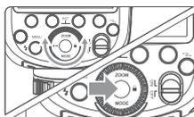
3 按下设置按钮，确定FEB(闪光包围曝光)。屏幕显示跳转到闪光曝光补偿和闪光包围曝光数值显示。
