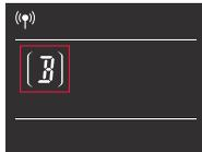
**Kanal CH:** Wählen Sie die Kanalschnittstelle. Drücken Sie kurz den CCT/FN-Drehknopf, der CH blinkt. Drehen Sie den CCT/FN-Drehknopf, um 32 Kanäle (1-32) auszuwählen.
