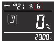
**Hinweis:** Die Sperrfunktion sperrt nur das Bedienfeld. Die drahtlose Steuerung wird von dieser Funktion nicht beeinflusst. Die 2.4G-Fernbedienung/APP kann immer noch den Leuchtenkörper steuern.
