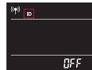
**Bluetooth-Rücksetzung:** Wählen Sie die Bluetooth-Schnittstelle. Halten Sie den CCT/FN-Drehknopf gedrückt. Das Bluetooth-Symbol blinkt und zeigt an, dass die Rücksetzung ausgeführt wird. Das Blinken stoppt und die Bluetooth-Rücksetzung ist abgeschlossen.
