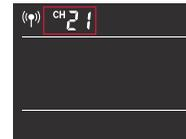
**ID-Nummer:** Wählen Sie die ID-Schnittstelle aus. Drücken Sie kurz auf den CCT/FN-Drehknopf, die ID blinkt. Drehen Sie den CCT/FN-Drehknopf, um OFF (AUS)/99 ID-Nummern (1-99) auszuwählen.
